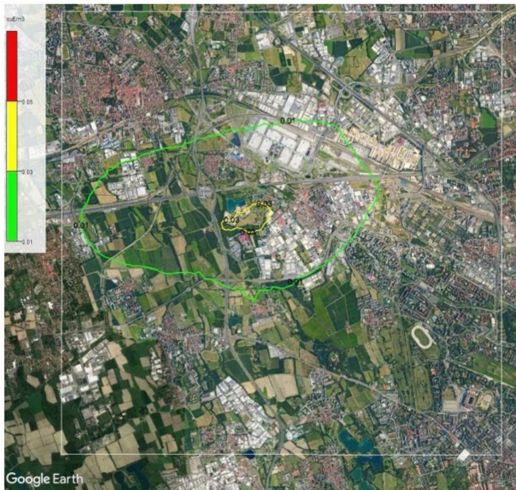
Figura 10. Mappa delle concentrazioni orarie di picco, valutate al 98esimo percentile, sul dominio di simulazione.
